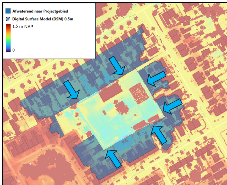
Figuur 4: Hoogte maaiveld (in mNAP) en oppervlak afstromend water richting plangebied
